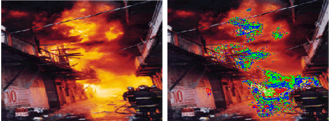
Figura 15 - A sinistra l'immagine in ingresso al classificatore, a destra l'immagine in uscita in cui sono evidenziati i pixel di fuoco
